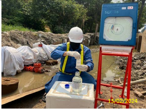
ข) ดำเนินการตรวจวัดคุณภาพน้ำก่อนระบายน้ำทิ้งจากการทดสอบท่อ
