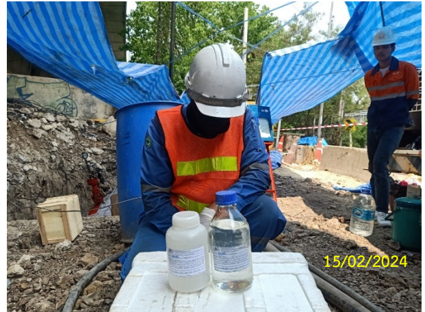
ข) ดำเนินการตรวจวัดคุณภาพน้ำก่อนระบายน้ำทิ้งจากการทดสอบท่อ
